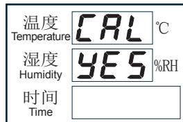
在正常运行界面下，依次按压“增加”、“减少”、“后移”、“选择/存储”键进入温度标定界面设置，按“增加”、“减少”键切换各界面。按“选择/存储”键配置参数初始化确认，显示“YES”，再按“选择/存储”键返回正常运行界面。
