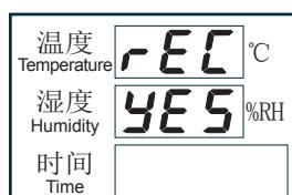
按“选择/存储”键标定值初始化确认，显示“YES”，再按“选择/存储”键返回正常运行界面。
