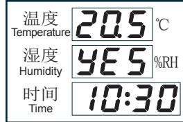
进入温度标定界面，温度值在闪烁，先按“选择/存储”键，再按“增加”或“减少”键修改温度值，按“选择/存储”键确认，显示“YES”，再按“选择/存储”键保存并返回正常运行界面。
