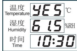
在正常运行界面下，依次按压“增加”、“增加”、“减少”、“选择/存储”键进入温度标定界面设置，按“增加”、“减少”键切换各界面。
