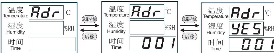
按“**后移**”键改变输入位，按“**增加**”、“**减少**”键改变输入值，按“**选择/存储**”键输入确认，显示“YES”，再按“**选择/存储**”键返回正常运行界面。
