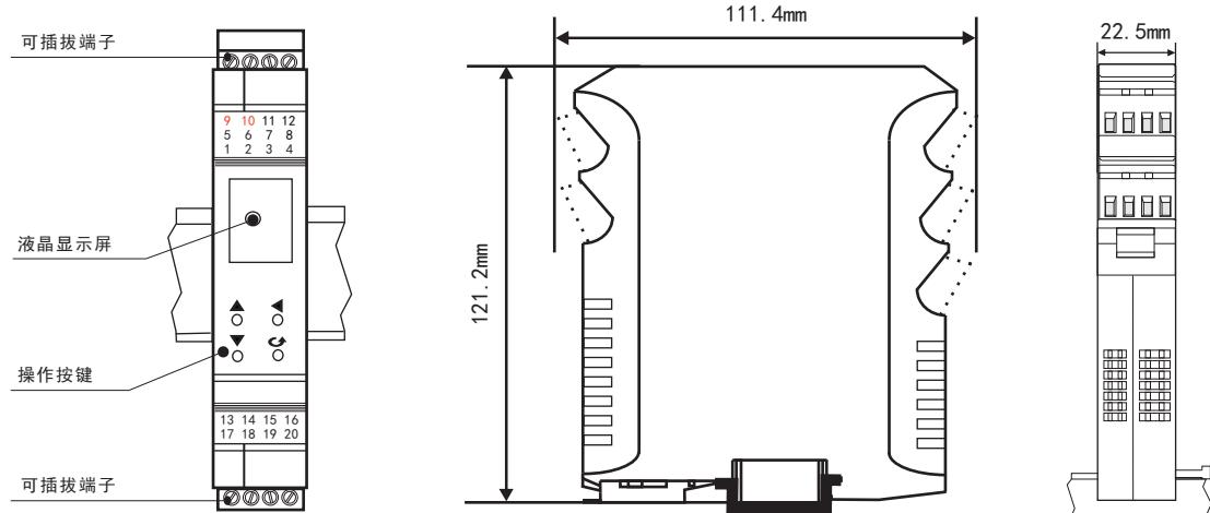
35mm导轨式安装，安装时请注意卡位稳定、牢固，请尽可能垂直安装，以利于仪表内部热量散发。
